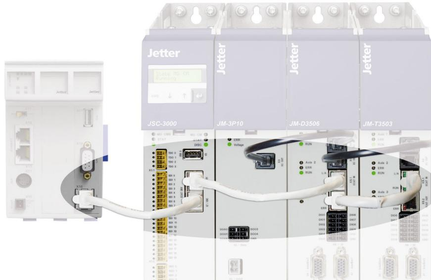
Abb. 3.16 EthetCAT-Verbindung (Beispiel)
